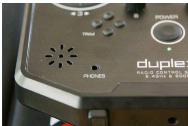
Une prise jack (pour ne pas déranger les pilotes sur la pente) et un haut-parleur de qualité permettent d'écouter les annonces vocales et le vario.
