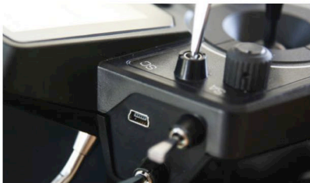
La prise mini-USB permet de connecter la radio à un ordinateur. La DS12 se comporte alors comme un simple disque dur. Les mises à jour se feront via cette connexion.
